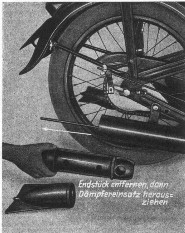
Abb. 25. Reinigen der Auspufftöpfe (Modell Leistritz).
