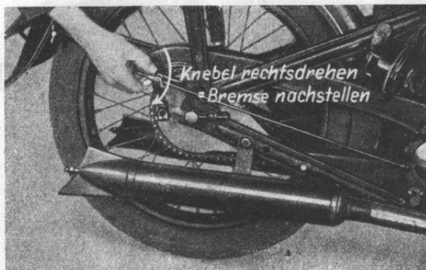
Abb. 33. Nachstellen der Hinterradbremse.
