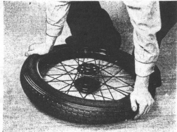
Abb. 20. Decke mit den Füßen in das Tiefbett drücken und, am Ventil beginnend, über den Felgenrand bringen.
