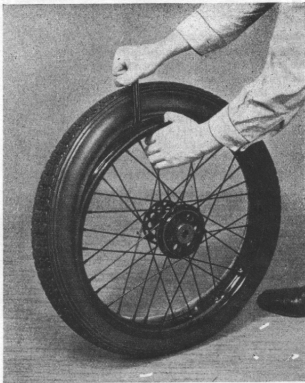
Abb. 17. Decke von der Felge abnehmen.
