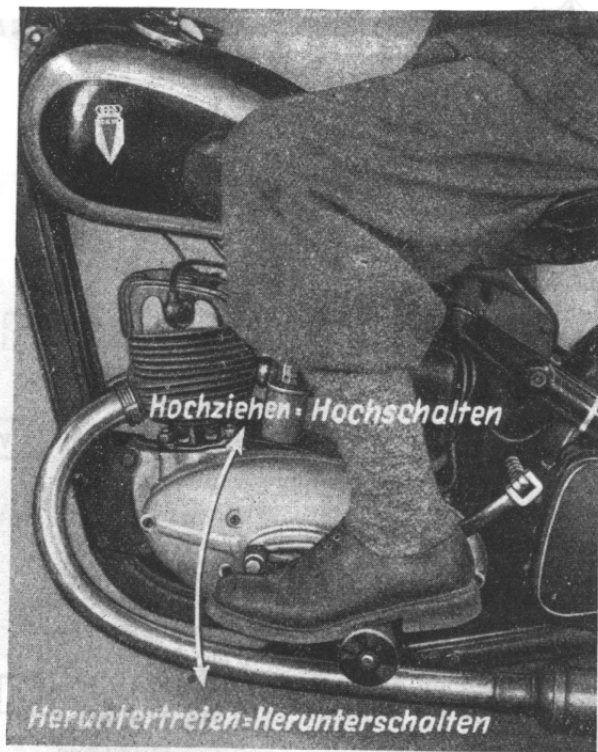
Abb. 7. Fußschalthebel.
