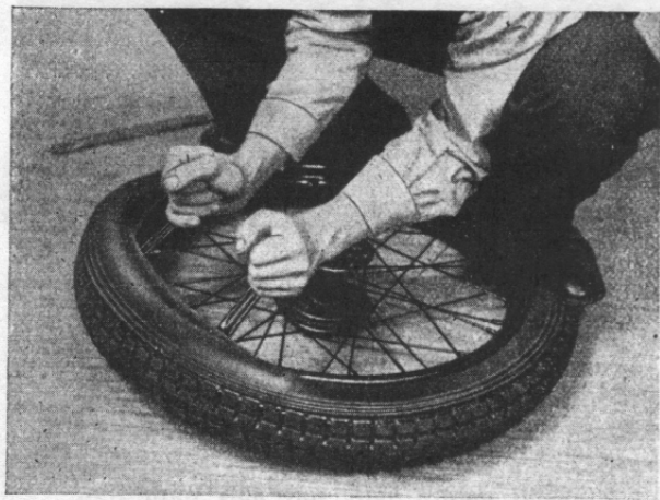
Abb. 21. Das letzte Stück läßt sich mit dem Montierhebel leicht über den Felgenrand drücken.
