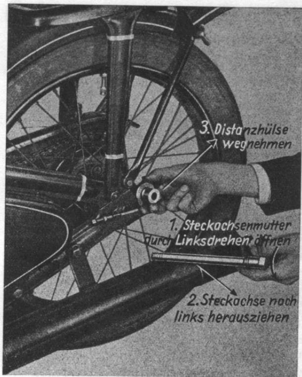
Abb. 13. Hinterrad-Demontage, Herausziehen der Steckachse.
