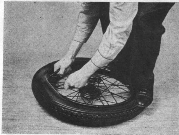
Abb. 16. Eindrücken der Decke in das Tiefbett, Decke an der gegenüberliegenden Seite über den Felgenreand drücken.
