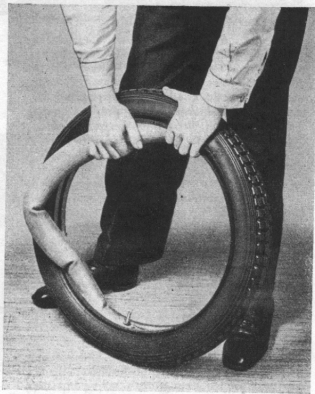
Abb. 18. Schwach aufgepumpten Schlauch einlegen.
