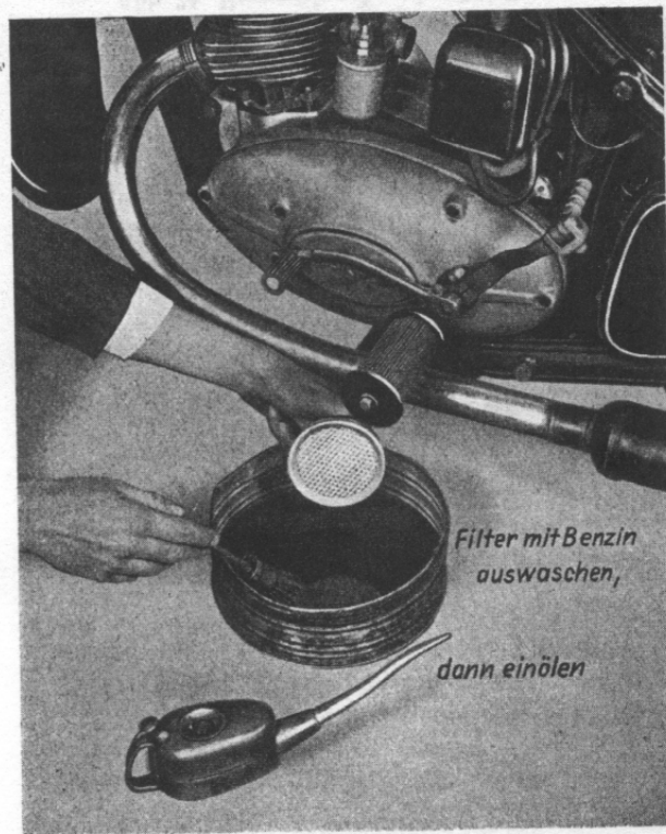
Abb. 23. Reinigen des Luftfilters.
